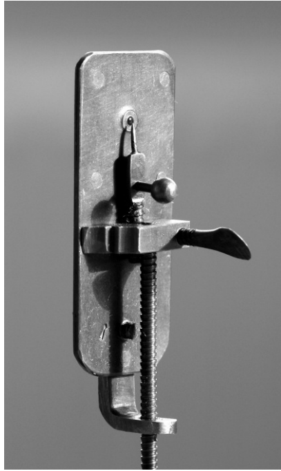
Fig. 3. Réplica de um microscópio simples (uma única lente) de Leeuwenhoek. Fonte: http://commons.wikimedia.org
